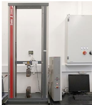
6. ábra ZWICK Z005 típusú számítógép vezérlésű univerzális szakítógép
